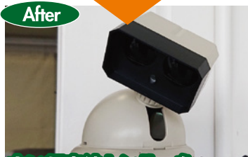
古い超音波センサーを新しい赤外線センサーに交換
