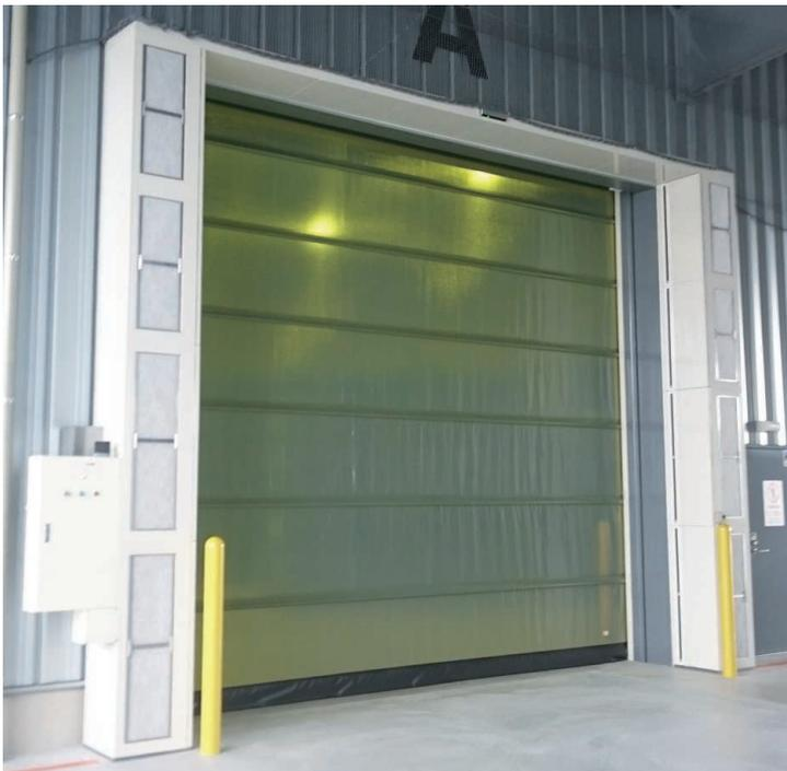
風速30m/秒の強風バリアが虫や塵埃の侵入を阻止します。センサーが検知すると、3秒前（※任意設定可能）に作動し、シートシャッターが開放中は風が吹き続け、閉鎖とともに停止します。鉄扉、ドア、シャッター等すべての開閉装置との組合せが可能です。
