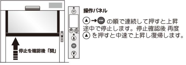
シート復帰後は、チューブ式やチューブ式ガイドなど破損していないか確認し、シャッターがスムーズに動作することを確認してください。
