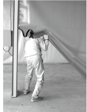
③ シートを潜り通過します。外れたシートは以下のシート復帰方法にて再度上限位置まで上げ復帰します。
